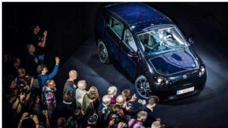
Den bare litt over fire meter lange elbilen Siion er pakket inn i 7,5 kvadratmeter solceller. Det er nok til å gi en 30 kilometers «gratis» kjøretur på solrike dager. (Foto: Sono Motors)
