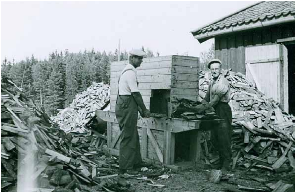
Vedkløyving ved Gunnar Høisveen (1914-99), til høyre, og Kjell Torp (1909-2000). Vedkløyveren var eid av flere og gikk på rundgang mellom husene. Selve vedkløyveren besto av et stort hjul med fastmonterte økser. Dette hjulet ble drevet av en elektrisk motor ved hjelp av ei lang, bred reim. Eier: Torild Tukun.
